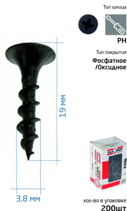
Саморез ШСГД 3,8x19 гипсокартон-дерево
