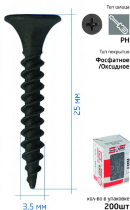
Саморез ШСГМ 3,5x25 гипсокартон-металл
